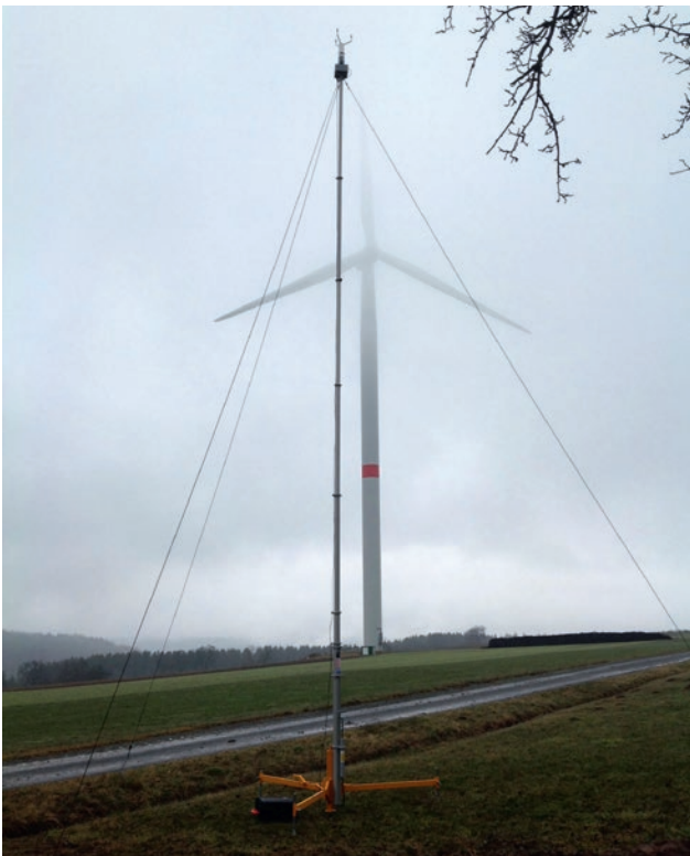
Abbildung 4.2-1: Windmessmast mit Blick in Richtung der zu messenden Windenergieanlage. Foto: Fa. Wölfel
