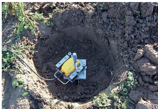
Abbildung 4.8-2: Erschütterungs-Messpunkt MP D auf Erdspeiß in 285 m Abstand von der WEA 5. Foto: Fa. Wölfel
